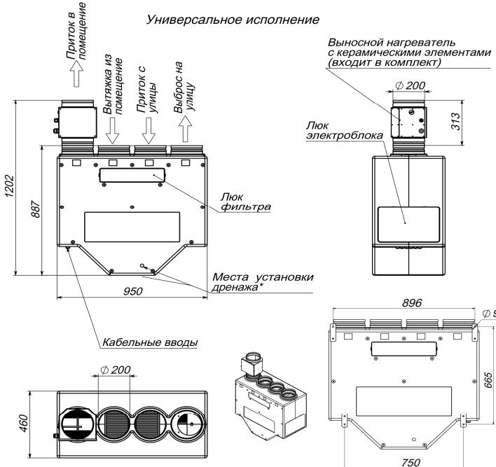
\* Комплект дренажа используется при влажности вытяжного воздуха выше 35%. Дренаж устанавливается в то из штатных отверстий, которое расположено в нижней точке оборудования.
