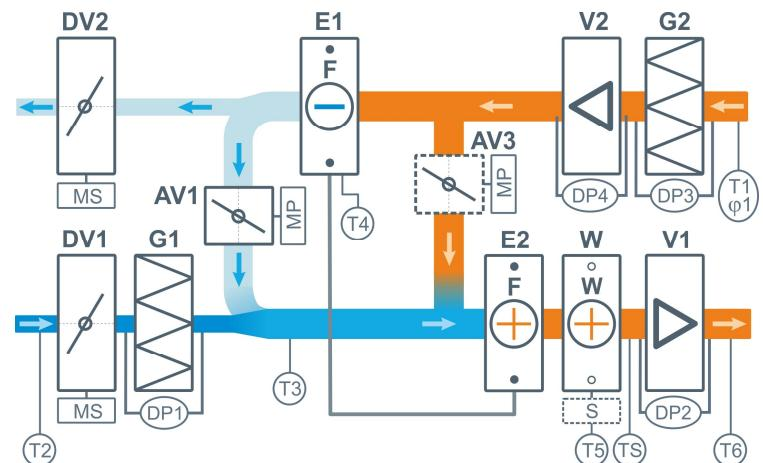
Для регионов с жарким и влажным климатом возможно использование теплового насоса в реверсивном режиме для охлаждения воздуха с выносным конденсатором (опция CE). Также возможно оснащение установки фреоновым охладителем и выходом для управления ККБ (опция CF).
