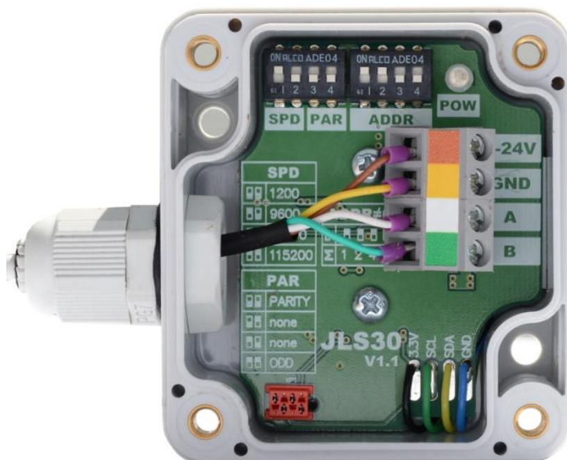
Рис. 9 - Вид на JLS30HC со снятой крышкой
