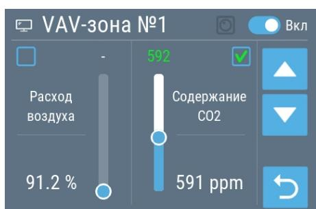
Если к зоне не подключен датчик, то VAV-зона работает только по процентному расходу и ползунок задания параметра становится неактивным.
