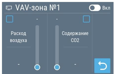
**Внимание!** Выключение всех VAV-зон одновременно допускается только, при условии, что активирована автоматическая остановка вентустановки при отключении всех VAV-зон (задается в сервисных настройках). VAV-зона считается выключенной, если заданный расход от ручного регулятора будет ниже 10% или же VAV-зона будет отключена с пульта.
