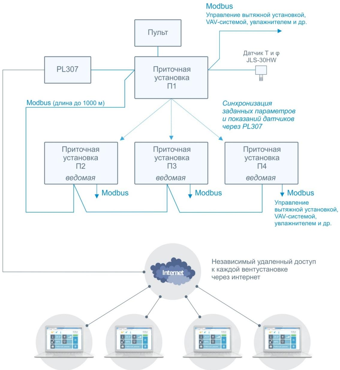
Для упрощения на схеме не показаны вытяжные установки и штатные пульты управления приточных установок П2, П3 и П4.
