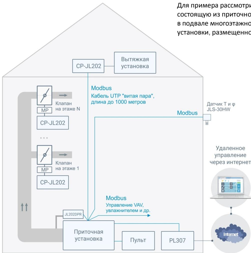
Длина кабеля между вентустановками – около 100 метров. Для управления вытяжной установкой необходимо использовать цифровой сигнал, поскольку аналоговый сигнал 0...10В нельзя передавать на большие расстояния. Управлять вытяжной установкой будет небольшой щит автоматики на базе модуля JL202DP, который соединяется с приточной установкой по шине Modbus.
